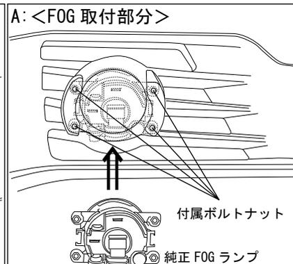
純正 FOG ランプを付属のボルトナットにて取付します。
