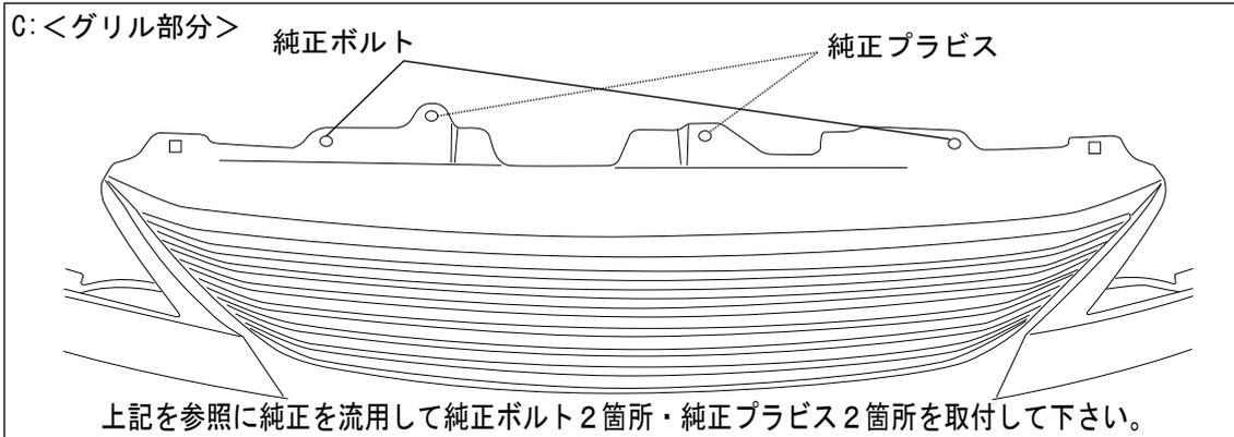
上記を参照に純正を流用して純正ボルト2箇所・純正プラビス2箇所を取付して下さい。
