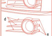
①FOG ランプを文字が書いてある 方向を上にしてはめ込みます。 ②上記図 d・e の各③箇所ずつを エアロバンパーに取り付けます。
