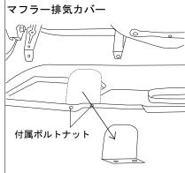
マフラー装着車の場合 エアロバンパー裏側の上記図破線 部分を外してご使用下さい。 ※マフラー非装着の場合は必ず使 用して下さい。
