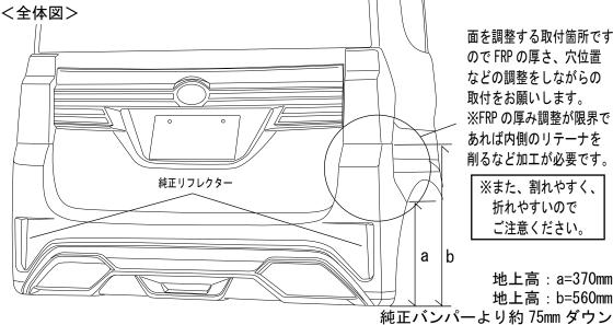
面を調整する取付箇所です ので FRP の厚さ、穴位置 などの調整をしながらの 取付をお願いします。 ※FRP の厚み調整が限界で あれば内側のリテーナを 削るなど加工が必要です。
