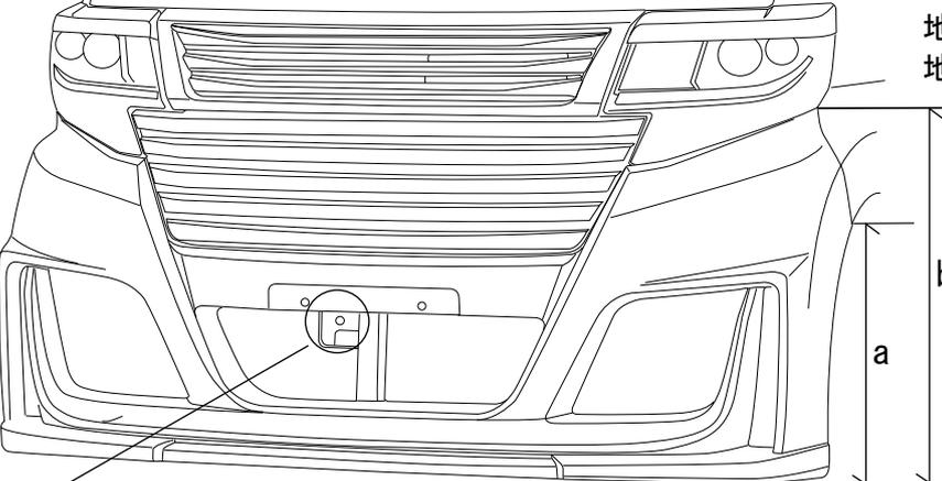
純正プラビスの穴を流用して付属のボルトナットにて取付けます。
