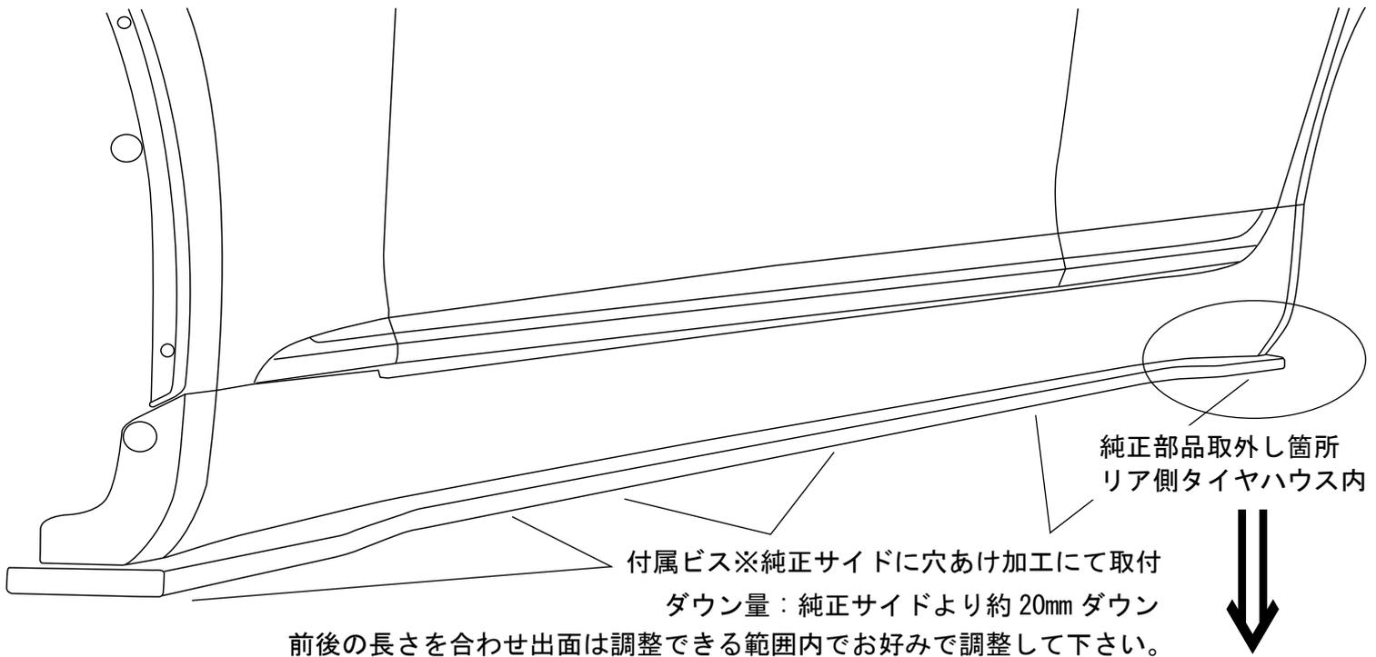
※重要※<純正部品取外し箇所>リア側タイヤハウス内 両側とも取り外して下さい。
