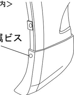
エアロパーツの穴に合わせて、した穴3mm程のあけて付属ビスにて取付して下さい。
