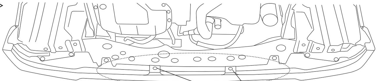
破線内の純正アンダーモールを取外して下さい。
