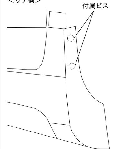
リア側は 3mm 位のした穴をあけ付属ビスにて取付します。
