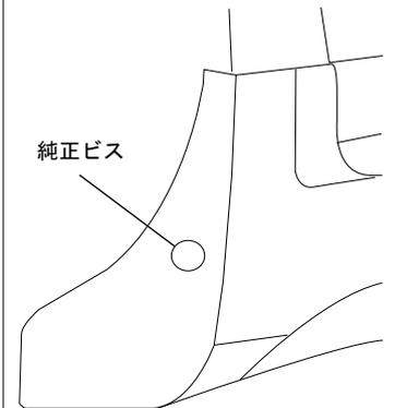
フロント側は純正ビスを流用して取付けて下さい。
