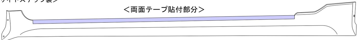
作業前にはフチゴム使用箇所と両面テープ使用箇所にシリコンオフやパーツクリーナー等で十分に脱脂をして貼り付け作業をして下さい。
