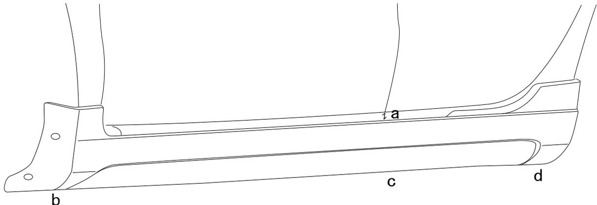
取付位置：a=10mm 地上高(純正ジャッキポイントより)約：b=10mm c=15mm d=20mm ダウン
