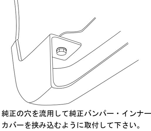
純正の穴を流用して純正バンパー・インナーカバーを挟み込むように取付して下さい。
