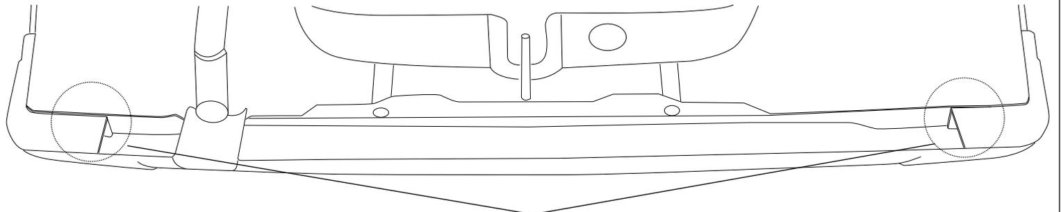
純正の穴を流用し付属のボルトナットにて2箇所を取付して下さい。
