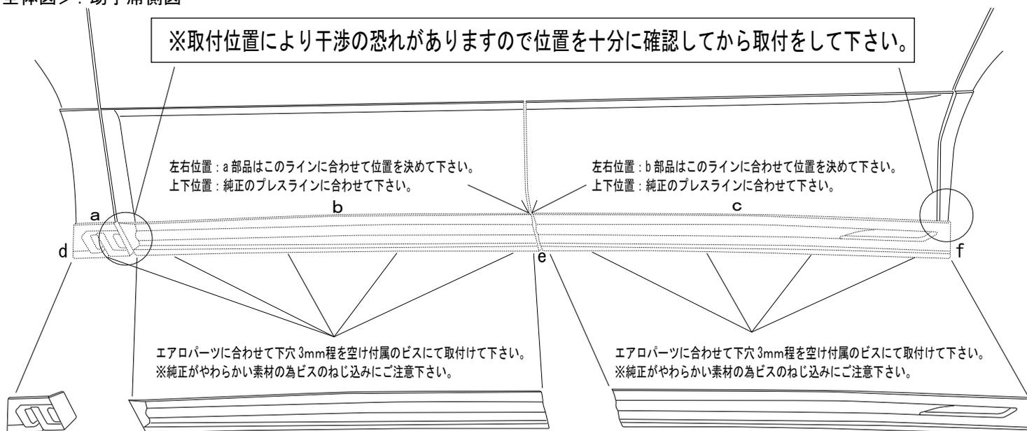
地上高 : d=85 mm e=115mm f=100mm 純正より一番低い箇所(リア f 付近) 約 75mmダウン
