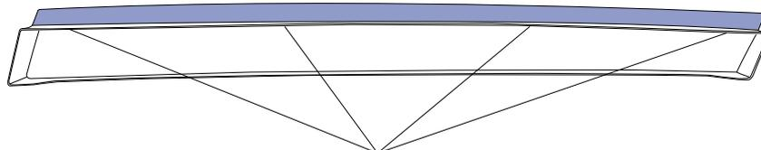
エアロパーツに合わせて下穴 3mm程を空け付属のビスにて取付けて下さい。
