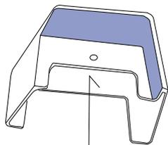
エアロパーツに合わせて下穴 3mm程を空け付属のビスにて取付けて下さい。
