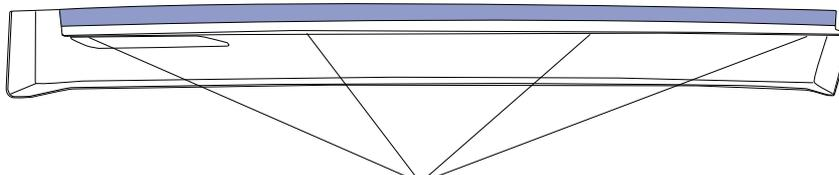
エアロパーツに合わせて下穴 3mm程を空け付属のビスにて取付けて下さい。
